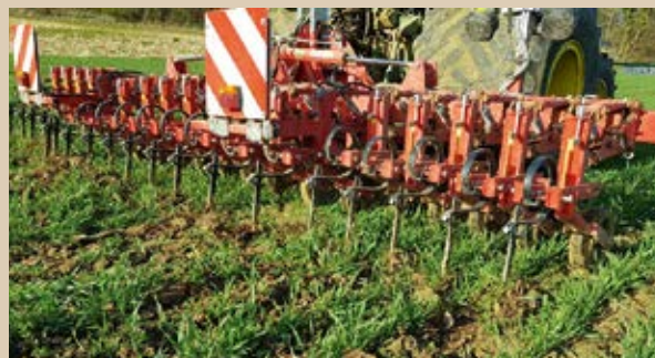
Striegel (Foto oben) und Hacke (Foto unten) werden eingesetzt, um Unkraut zu entfernen, ohne dass Unkrautvernichtungsmittel eingesetzt werden müssen. (Fotos: Urkornpuristen)
